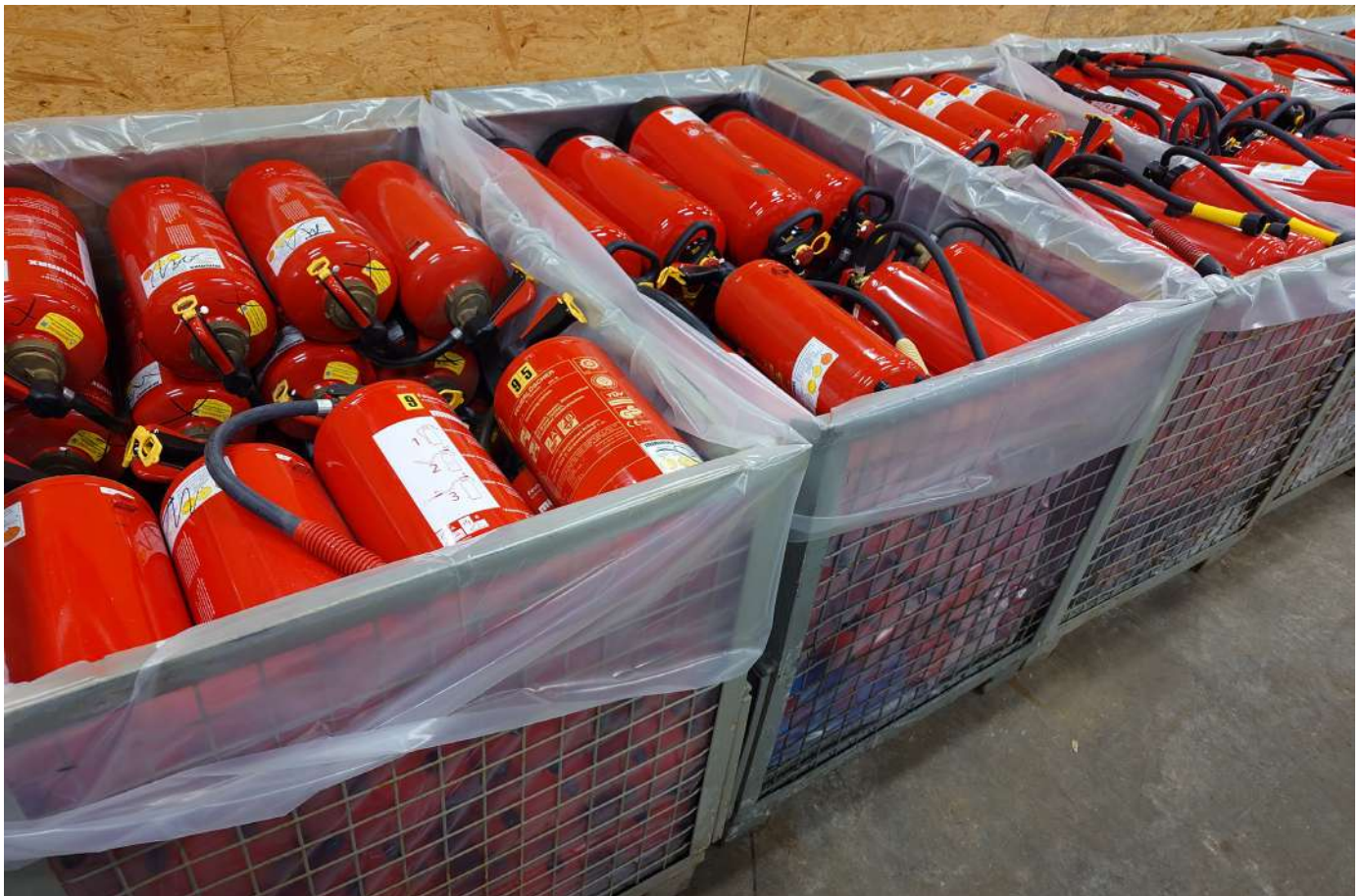
Mit speziellen Foliensäcken ausgelegte Gitterboxen für Altlöscher mit Flüssiglöschmitteln
